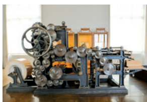
Presse typographique rotative à plieuse système Marinoni, 1880-1886.
