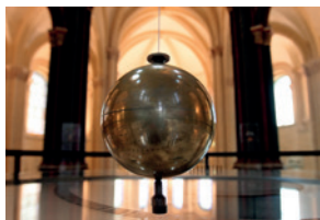
Le pendule de Foucault (1851), dispositif permettant de mettre en évidence la rotation de la Terre sur elle-même.
